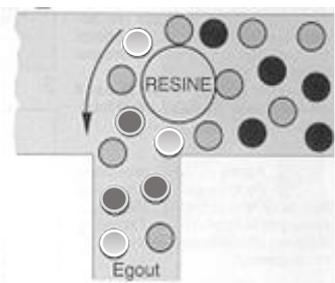
**Etape 5 :** La résine est totalement saturée en sodium, prête à l'emploi.
