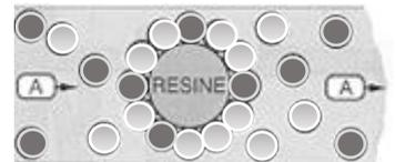
**Etape 4 :** La résine est régénérée avec de la saumure permettant de la débarrasser du calcaire de la résine pour l'évacuer à l'égout.
