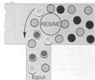
**Etape 5 :** La résine est totalement saturée en sodium, prête à l'emploi.
